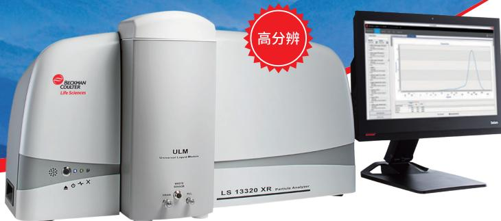
贝克曼库尔特公司新一代 LS 13 320 XR 将激光衍射粒度分析仪提升到了一个更高的水平，升级版 PIDS 专利技术（发明专利：4953978, 5104221）、优化的132枚检测器，保证了仪器分辨率更高，结果更准确，再现性更好。您不仅可以测量粒径范围更宽的颗粒，而且可以更快、更可靠地检测到颗粒粒径间极细微的差异。并且新软件的操作界面更加直观，仅需点击几次便可获得您需要的数据。
